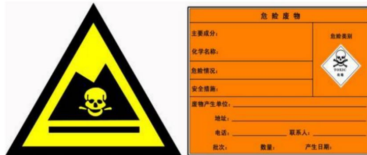
图 4-2 废警示三角标识、危废贮存容器小标签
